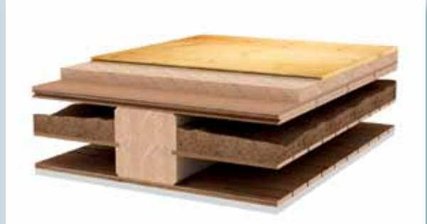
Svømmende gulv på træfiberunderlag på eksisterende gulvbrædder
